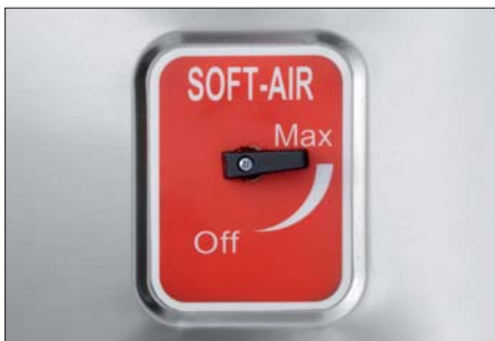
Cod. 1408V015 Soft air Soft air Soft Air (système de remise progressive à l'atmosphère) Soft air
